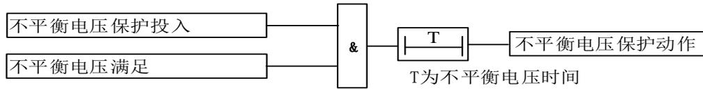
图 3-1-5 不平衡电压保护原理框图
