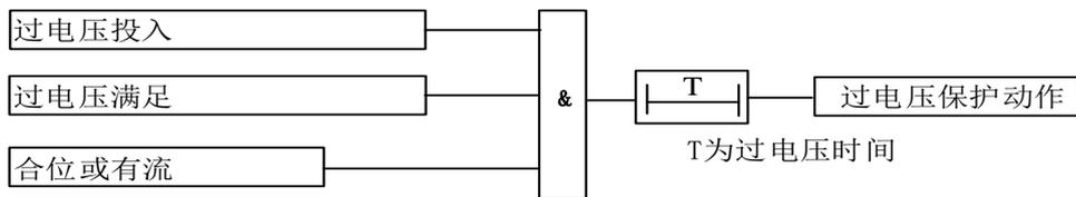
图 3-1-3 过电压保护原理框图
