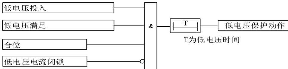
图 3-1-4 低电压保护原理框图
