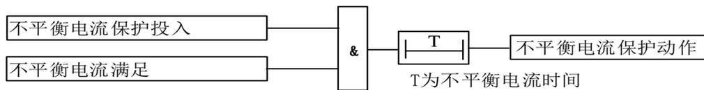
图 3-1-6 不平衡电流保护原理框图
