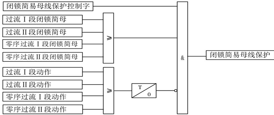
图 3-1-8 闭锁简易母线保护原理框图
