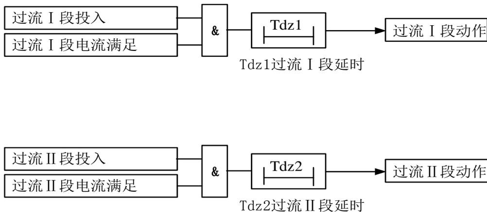
图 3-1-1 过流保护原理框图
