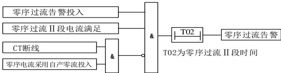
图 3-1-2 零序过流保护原理框图
