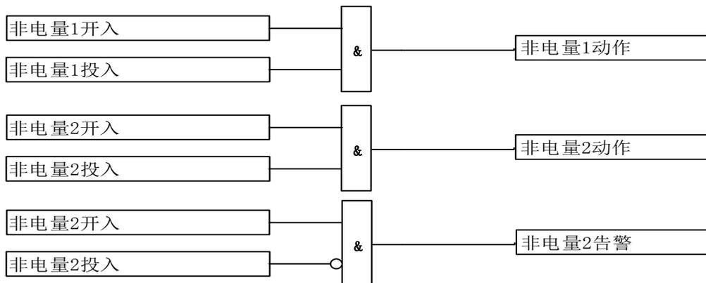
图 3-1-7 非电量保护原理框图
